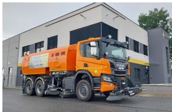
Nákladní automobil Scania se zametací nástavbou
